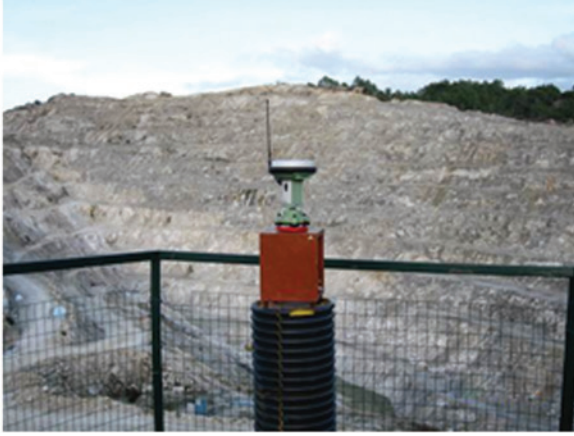
Şekil 3. Ocağın KB köşesine konumlandırılmış sabit ve gezici GPS üniteleri.
