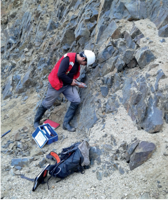
Şekil 4. Schmidt çekici uygulaması. Figure 4. Application of Schmidt hammer in the field.
