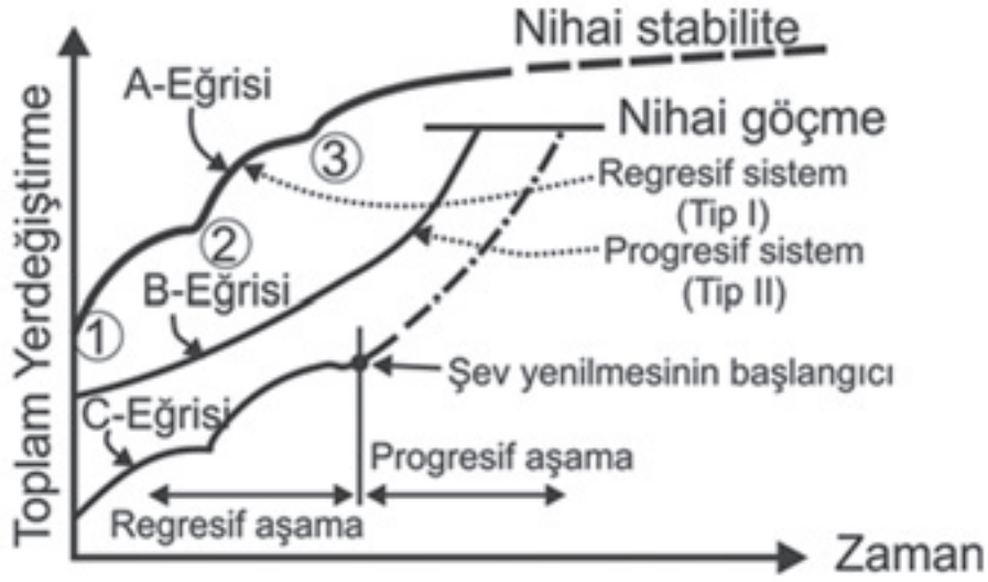
Şekil 2. Regresif ve progresif şev hareketi yer değiştirme eğrileri (Zavodni, 2000).
